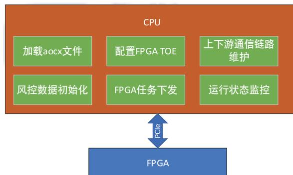
FPGA 本身没有任何逻辑, 依赖于外部给其设计内部逻辑电路。风控业务开发完成后, 会生成用于加载到 FPGA 上的 AOCX 文件。该文件包含 FPGA 内部逻辑电路设计。通过主机程序, 调用 OpenCL 的接口, 可以完成 FPGA 上的业务逻辑的重新配置, 即将业务逻辑、TOE 和 PAC 卡本身的静态逻辑加载到 FPGA 中。而 TOE 功能, 则需要主机程序先配置 FPGA TOE 的 MAC 地址、IP 地址。风控方案一般是上游连接客户策略, 下游连接柜台, 上下游通信链路的建立页依赖于主机程序来进行建立和维护。风控本身会需要一些账户初始化资金、持仓、期权基础信息等, 这些数据一般只能通过主机程序或者, 然后写入 FPGA 内部。FPGA 执行哪些任务, 或者执行哪些任务组合, 也都是通过 CPU 来控制。最后是整个风控系统的运行状况, FPGA 板卡的状态, 也都是交由主机程序来监控。
