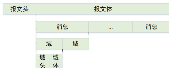
图 2 行情报文结构示意图
